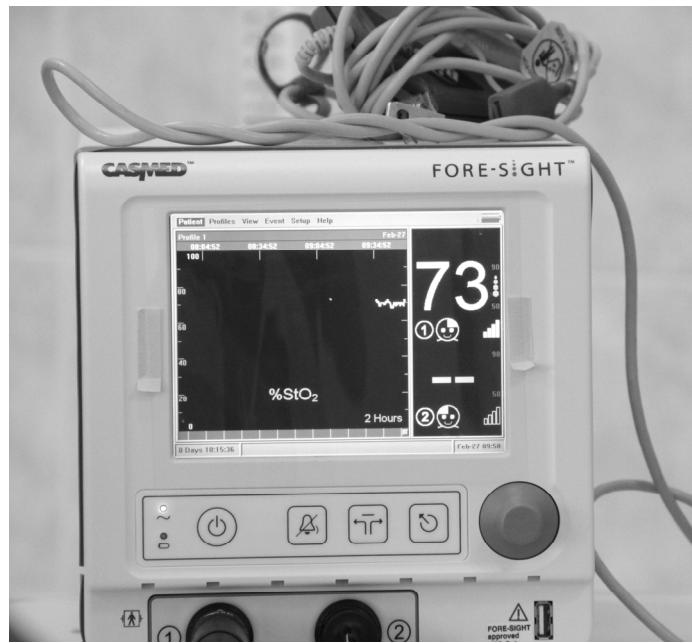
*Рисунок 2. Церебральный оксиметр FORE-SIGHT компании CASMED*
